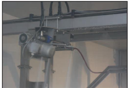
Die eingesetzte Hochdruckpumpe liefert 70 bar bei einem Volumenstrom von 70 l/min und erzeugt somit den notwendigen Arbeitsdruck.
