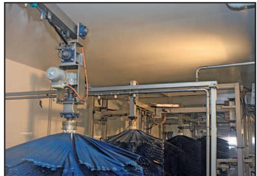
Bei Verwendung als Wäscher sorgen die drei rotierenden Walzen für eine sehr gute Entfernung des Schmutzes. Speziell in Kurzwaschbahnen ist der Einsatz dieses Aggregates daher eine sinnvolle und platzsparende Lösung.
