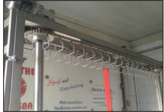
Die Textilaufnahme erfolgt an einer galvanisch verzinkten Kette, dadurch ist die Wartung auf ein Minimum reduziert.
