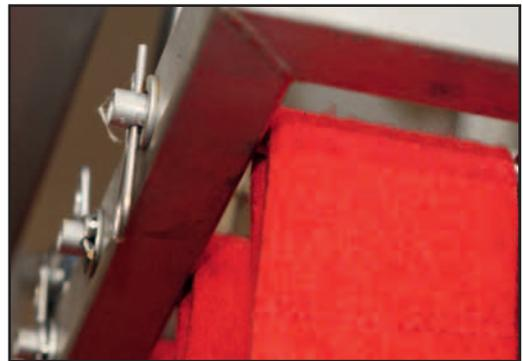
Durch eine Verbreiterung des Rahmens besteht die Möglichkeit zum Unterbau verschiedener Komponenten, z. B. Schwellerwäscher oder Mitfahrender Hochdruck-Rad/Schwellerwäscher.
