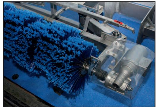
Hartnäckige Ablagerungen durch Streusalze, Bremsstaub und anderen festgesetzten Schmutz können hiermit entfernt werden.
