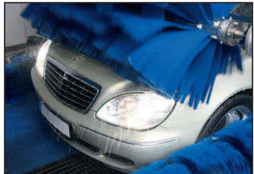
Dachwalzenaggregate werden zur gründlichen Reinigung der Fahrzeugoberseite eingesetzt.
