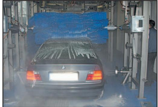
Wahlweise ist das Dachwalzenaggregat in gekröpfter Ausführung zum platzsparenden Unterbau anderer Komponenten lieferbar, z. B. Schwellerwäscher, Mitfahrender Hochdruck-Rad/Schwellerwäscher.
