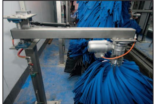
Auf Wunsch kann das Kurzwalzenaggregat auch mit Pneumatikzylindern ausgestattet werden. Dadurch wird eine definierte Ansteuerung möglich.
