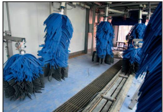
Das Kurzwalzenaggregat in der Waschzone verstärkt und unterstützt die gründliche Reinigung der Fahrzeugseiten und der Front, die oft verstärkt von Schmutzanhaftungen betroffen sind.
