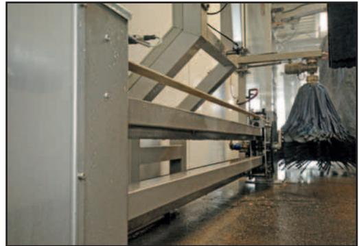
In Verbindung mit einem gekröpften Aggregat, wie z. B. Dachwalze oder 3-Walzen-Rundumaggregat, ist ein platzsparender Einbau möglich.
