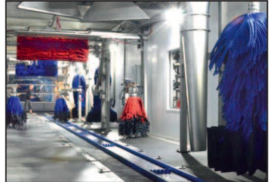
Die V-förmige Anordnung der Dachdüsen sorgt für ein mittenüberdeckendes Abschalen der Wasserperlen von der Fahrzeugoberseite.
