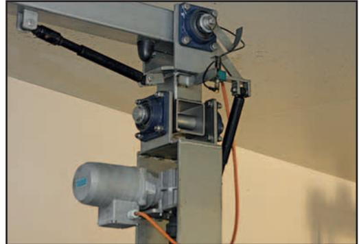
Das Aggregat besteht aus einer soliden, glasperlgestrahlten Edelstahlkonstruktion. Die Dachwalze und die beiden Seitenwalzen können wahlweise mit Wasch- oder Trocknertextil bestückt werden.
