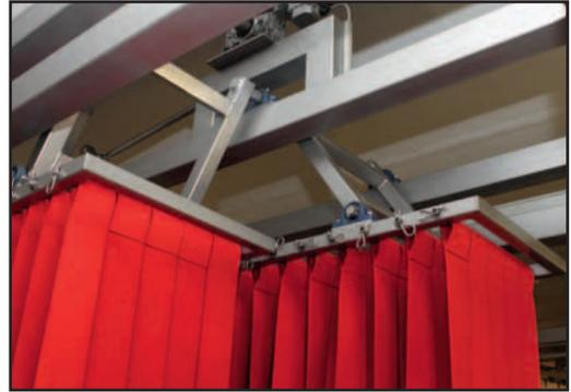
Lieferbar wahlweise als Front-to-Back-Mitter oder als Side-to-Side-Mitter. Beim Front-to-Back-Mitter agieren die Textilstreifen in Fahrtrichtung, beim Side-to-Side-Mitter dagegen quer zur Fahrtrichtung.
