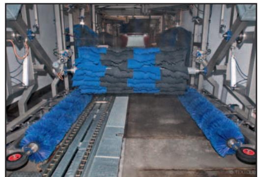
Die Bandgeschwindigkeit wird durch einen Frequenzumrichter geregelt.
