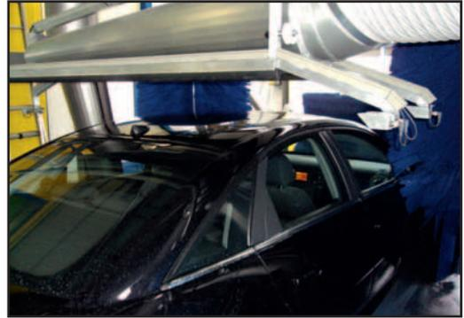
Die konturfolgende Dachdüse verfährt während des Trocknungsvorgangs stets in einem definierten, gleichbleibenden Abstand zur oberen Fahrzeugkontur.
