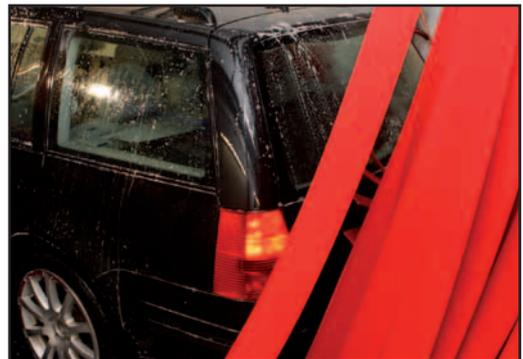
Die Tuchbenetzung erfolgt bei beiden Systemen mittels Breitstrahldüsen. Der Antrieb erfolgt über einen Elektromotor.
